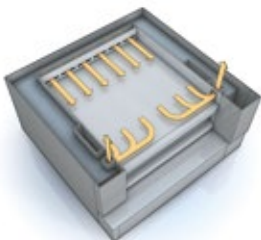
Schnitt durch den Herd – Schwadenverteilssystem
