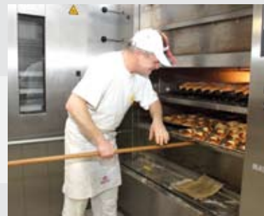
Nicht nur das Laugengebäck zeichnet sich durch eine gleichmäßige Bräunung aus. Grund dafür ist das Zyklotherm-Heizsystem des Matador, das dafür sorgt, dass die heißen Heizgase vorne im temperaturempfindlichen Ofenbereich eintreten.
