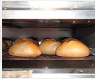
Die 19,8 cm hohen und mit 1.200 mm zweifach breiten Herde des Matador MD 101 gewährleisten eine gleichmäßige Wärmeabstrahlung in ruhender Backatmosphäre und sind serienmäßig mit Spezial-Steinbackplatten ausgestattet.
