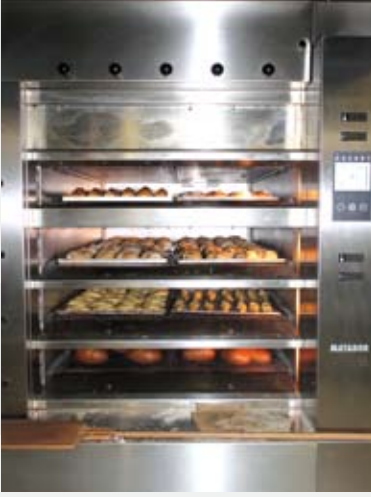
Der Matador von Strobel verfügt über zwei getrennte Heizkreise, die beiden oberen Herde sind durch einen dickeren Boden von den drei unteren getrennt und können mit Hilfe des Combitherm-Systems bis zu 40 °C kältere Temperaturen fahren.
