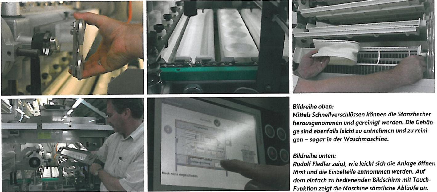
**Bildreihe oben:** Mittels Schnellverschlüssen können die Stanzbecher herausgenommen und gereinigt werden. Die Gehänge sind ebenfalls leicht zu entnehmen und zu reinigen – sogar in der Waschmaschine.
