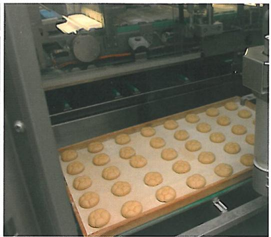
Komplettiert wird die Anlage durch den Roboter „Robomatic S“ – er ersetzt den Mitarbeiter, der bislang den ständigen Dielen- und Blechwechsel vornehmen musste.
