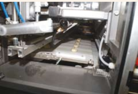
An der Schneidestation sorgt ein Niederhalter für gleichmäßige Ergebnisse.
