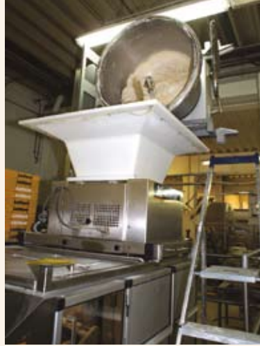
Vom Hebekipper fällt der Teig zunächst in den Vorportionierer.
