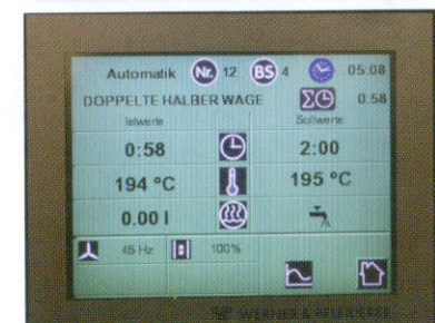
Die Navigo-Steuerung bietet ein vollautomatisiertes Backprogramm mit beliebig programmierbaren Backschritten und Temperaturverläufen.
